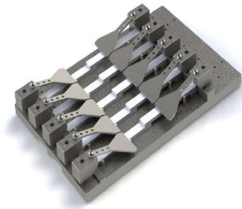
Figura 1. Esquema de proceso de pegado en herramental para probetas. Fuente: elaboración propia.
