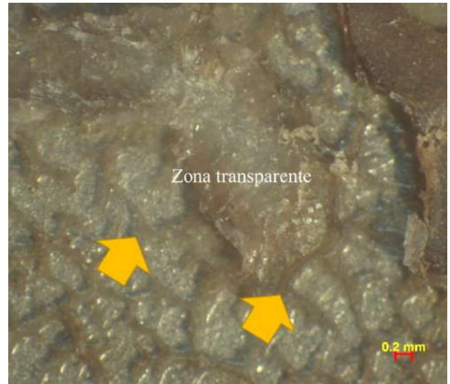
Figura 3. Imagen a mayores aumentos de la zona falla cohesiva-adhesiva (30X de magnificación). Fuente: elaboración propia
