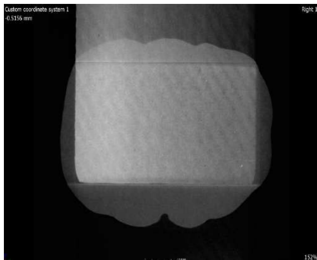
Figura 7. Vista superior de la unión aluminio-aluminio sin defectos. Fuente: elaboración propia
