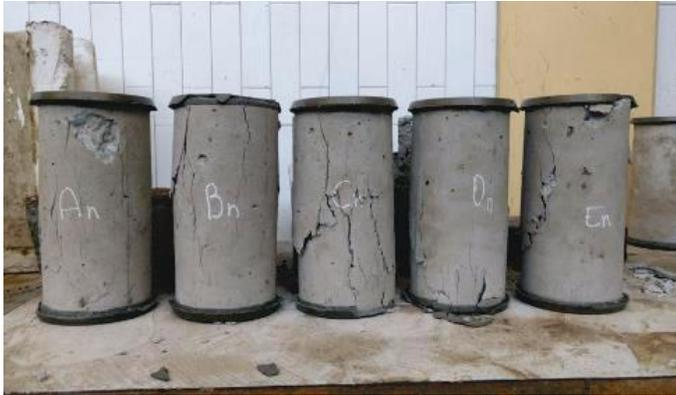
Fig. 1. Especímenes ensayados de concreto normal
