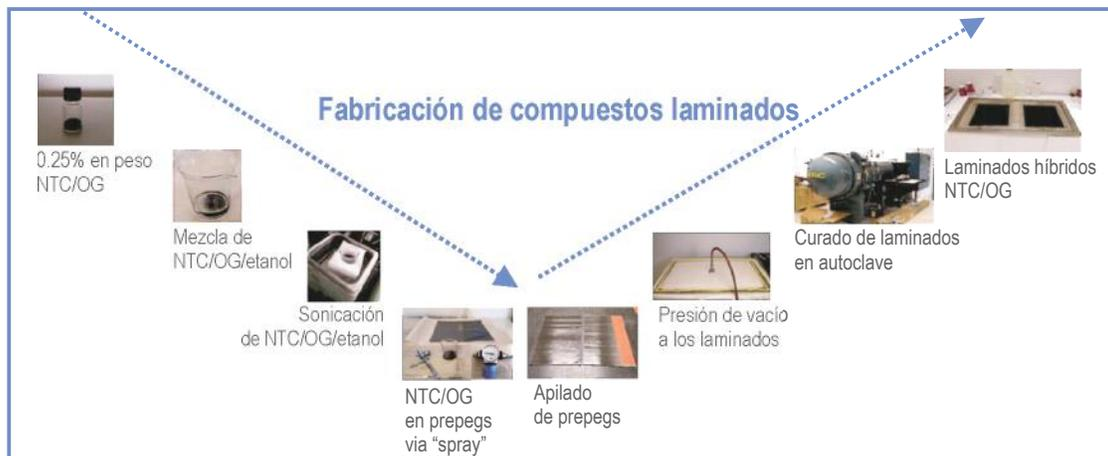
Figura 1. Esquema que muestra el procedimiento de fabricación de compuestos laminados híbridos.
