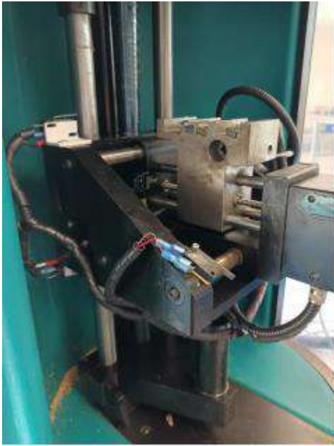
Imagen 3 Sensores de límite colocados en el interior de la máquina Espinos, N. (2023)
