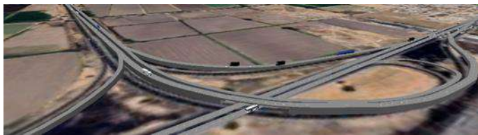
Figura 3. Red vial del Distribuidor Crespo dibujada en PTV Vissim. Fuente: Elaboración Propia
