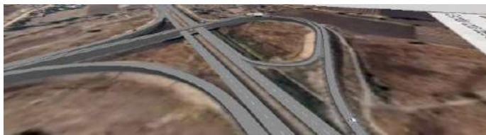
Figura 4. Red vial del Distribuidor San Miguel dibujada en PTV Vissim. Fuente: Elaboración Propia
