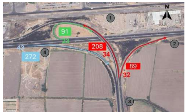
Figura 5. VHMD por movimiento direccional en el Distribuidor Crespo. Fuente: (Google Earth, 2025)
