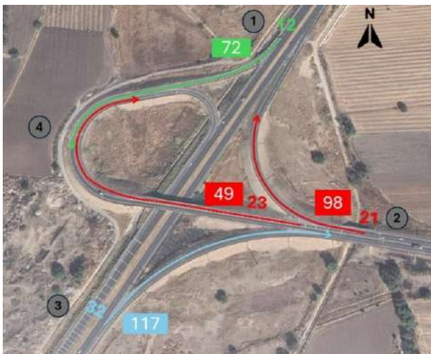
Figura 6. VHMD por movimiento direccional en el Distribuidor San Miguel. Fuente: (Google Earth, 2025)
