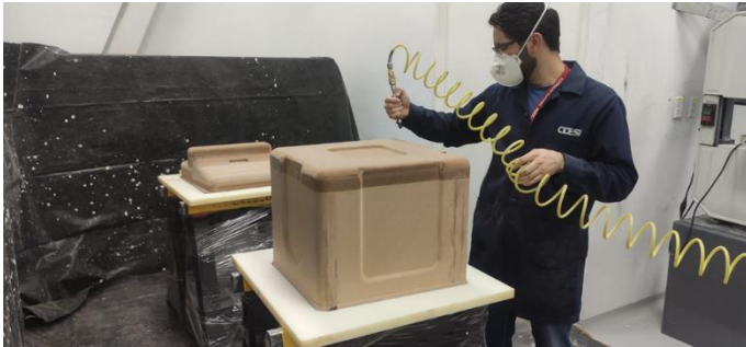
Figura 3. Fotografía representativa del proceso de limpieza de los moldes MDF maestros. Fuente: elaboración propia
