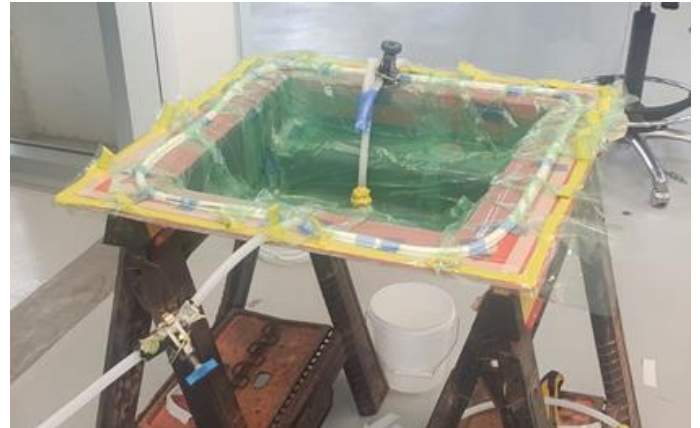
Figura 8. Fotografía representativa del arreglo del proceso de infusión asistida por vacío para la fabricación de las carcasas estructurales correspondientes al ventilador prototipo. Fuente: elaboración propia
