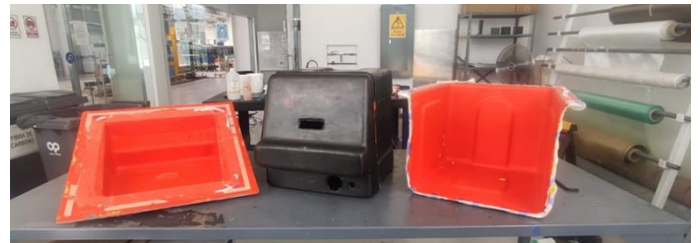
Figura 9. Fotografía de los moldes MAT de fibra de vidrio (en rojo) y el monitor estructural de fibra de carbono (en negro) para el ventilador mecánico prototipo. Fuente: elaboración propia
