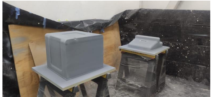
Figura 5. Fotografía representativa del aspecto de los moldes MDF maestros posterior al tratamiento de sellado. Fuente: elaboración propia
