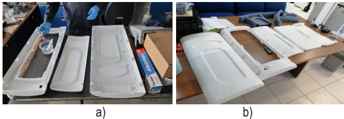
Figura 11. Fotografías representativas del acoplamiento de las piezas impresas en 3D: a) refuerzo en la parte posterior de las carcasas de PLA mediante fibra de vidrio tipo MAT con resina poliéster, b) carcasas acopladas. Fuente: elaboración propia
