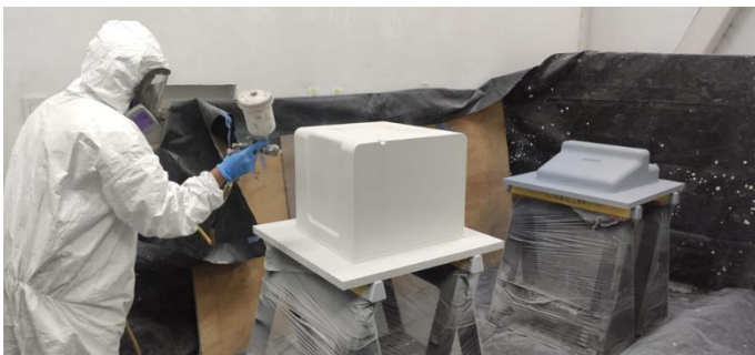
Figura 4. Fotografía representativa de la aplicación de sellante a través de una pistola de gravedad. Fuente: elaboración propia
