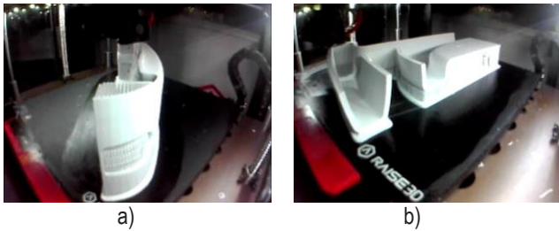
Figura 10. Proceso de impresión 3D de distintas piezas del ventilador mecánico prototipo: a) pedestal, b) base. Fuente: elaboración propia
