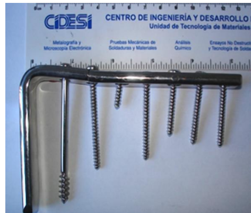
Figura 3.- Prótesis metálica en la condición de entrega al laboratorio, posición de la fractura. Fuente: elaboración propia.
