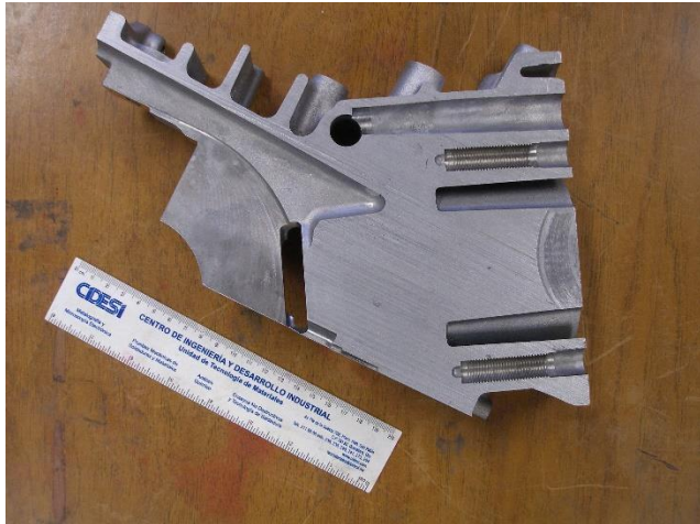
Figura 7.- Corte transversal de la pieza de aluminio fundido donde se localizaban los barrenos con fuga durante la prueba neumática. Fuente: elaboración propia.
