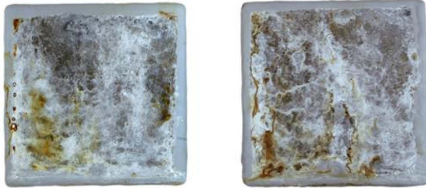
Figura 11. Placas recubiertas de aluminio por la técnica PVD a una exposición de 100 horas. Fuente: elaboración propia
