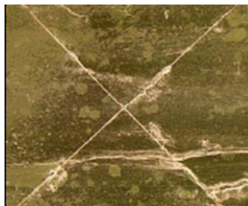
Figura 10. Placa de cadmio con una exposición 100 h con la incisión en X. Fuente: elaboración propia
