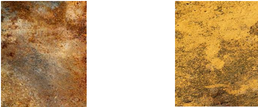
Figura 12. Placas recubiertas de aluminio por la técnica CVD, a la izquierda con un tiempo de exposición de 850 hrs y, a la derecha 100 horas. Fuente: elaboración propia
