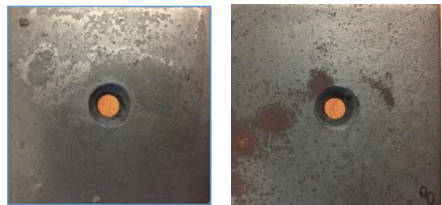
Figura 6. Cupón con el recubrimiento de Ni-30%Al (izq.) y metal base desnudo (der.) después de un mes de exposición en la Unidad Geotérmica. Fuente: elaboración propia.
