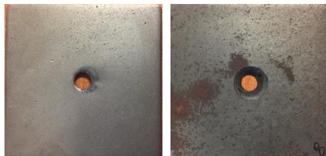
Figura 8. Cupón con el recubrimiento de Ni-30%Cr (izq.) y metal base desnudo (der.) después de un mes de exposición en la Unidad Geotérmica. Fuente: elaboración propia.
