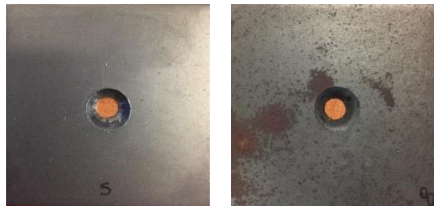
Figura 10. Cupón con el recubrimiento de Ni-30%Ti-10%B (izq.) y metal base desnudo (der.) después de un mes de exposición en la Unidad Geotérmica. Fuente: elaboración propia.
