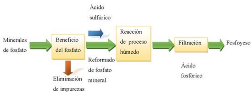
Figura 1. Diagrama de flujo del proceso simplificado para producción de ácido fosfórico. En la industria el contenido de fósforo se mide bajo la forma de P 2 O 5 . Este contiene un 44% de riqueza en fósforo (P). Esquema basado en información de Gilmour (2014). Fuente : elaboración propia.
