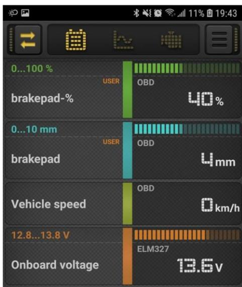
Figura 10. OBDII Balatas al 40%. Fuente: VRP
