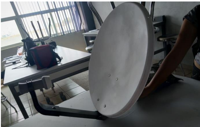
Figura 1. Antena tipo offset para banda KU de 60 cm de diámetro con un LNB sencillo.
