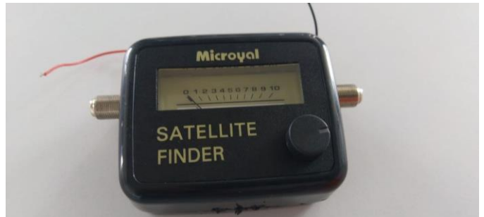
Figura 4. Buscador satelital con los cables del zumbador desconectados, para medir la diferencia de voltaje.
