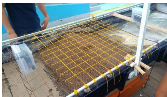
Fig. 6. Mallado de la sección del canal a estudiar.
