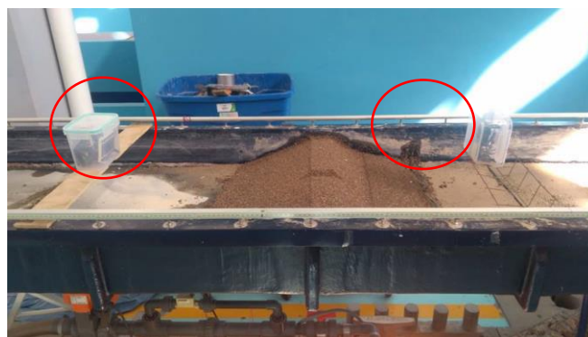
Fig. 12. Ubicación y colocación de sensores ultrasónicos en el canal de fondo móvil.
